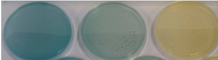
Illustration 1: Viser farveudviklingen af PCA-mediet, tilført 0,24 g/L bromthymolblåt, efter 72 timers inkubation med bakterierne E. coli (venstre), E. faecium og B. longum (højre) samt kontrol (midt).
