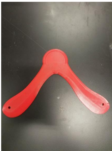
Figur 4 - Billedet viser en af vores 3D printede boomeranger. Flapsformene vender modsat hinanden og den er derfor ubrugelig.
